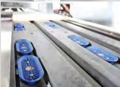
加工区域全台面吸真空装置 确保证设备加工时工件的稳固
