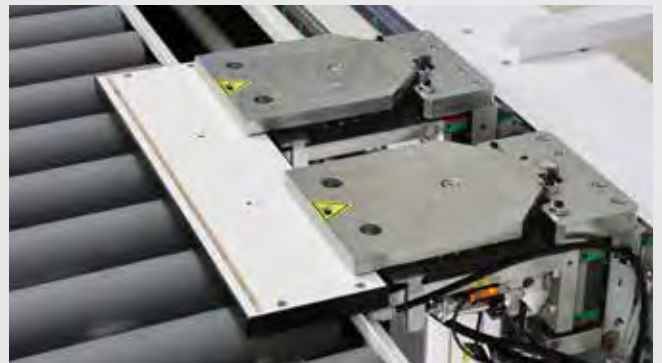
两侧CNC控制动态夹钳系统
