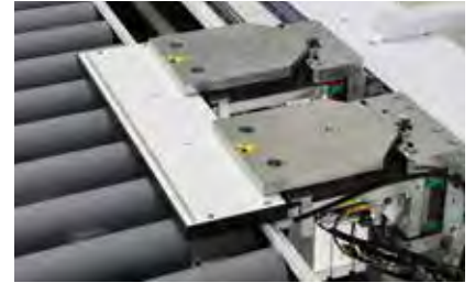
两侧CNC控制动态夹钳系统
