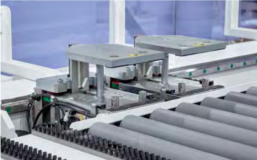
两侧CNC控制动态夹钳系统
