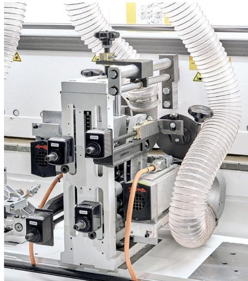
**斜角/圆弧精修装置：**手动调节斜角和圆弧加工。
