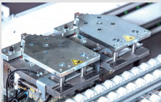
两侧CNC控制动态夹钳系统
