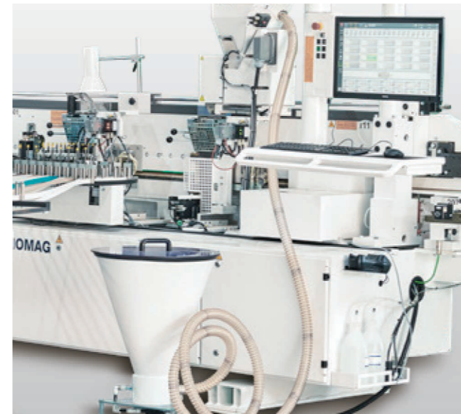
EVA热熔胶颗粒自动打胶装置 ▪ 将热熔胶颗粒自动输送至预熔胶箱内
