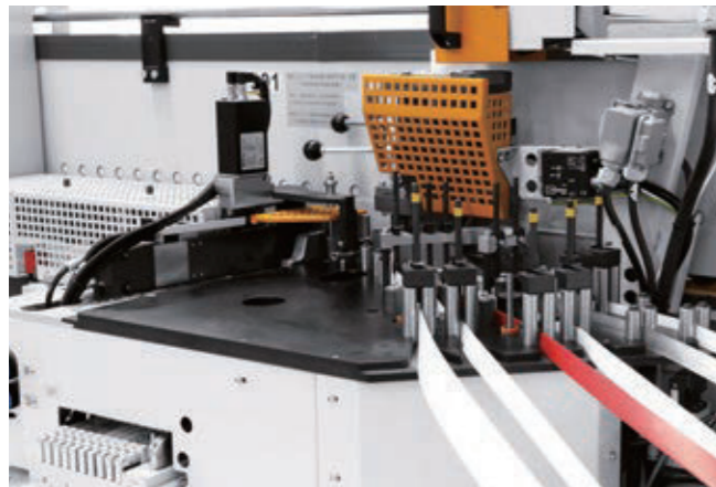
6卷封边带库 (选配) 6卷不同封边带自动进料。
