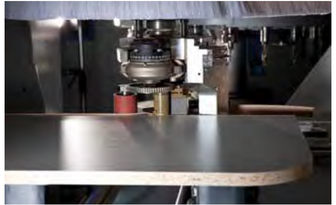
easyEdge封边装置, 适用于异型部件的完美封边
