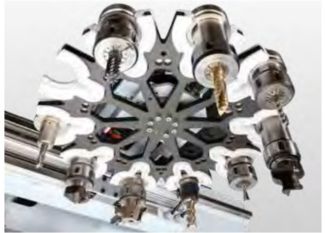
10位刀库 , 随主轴移动。在钻孔或封边时换刀。用于直径达180mm的刀具和转换头。
