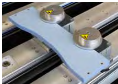
多功能夹具 ，用于双回路真空系统。真空驱动 的夹具，用于夹紧条状工件和小部件。
