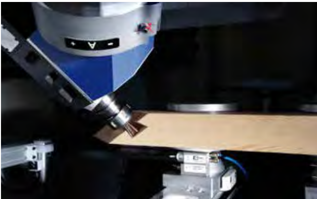
镗铣燕尾槽用于竖框/横框连接
