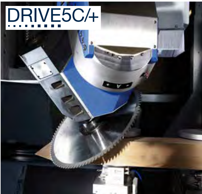
5 轴镟铣主轴DRIVE 5C/+ , 配备10kW功率 (可选12或15kW), 主轴转速可控, 可高达24,000rpm, 即使在低转速下也能获得高扭矩。
