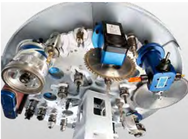
32位刀库 — 刀具排列在内环和外环当中。适用于直径达200mm的刀具和转换头, 以及直径达350mm的锯片 (外环)。
