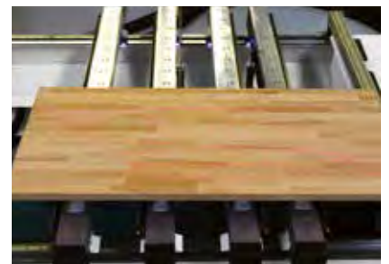
激光投影 夹具和工件轮廓的可视化利用, 用于定位杆不能靠齐的工件坯料的简单定位。
