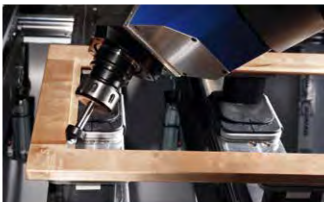
玻璃洞口的直角企口加工
