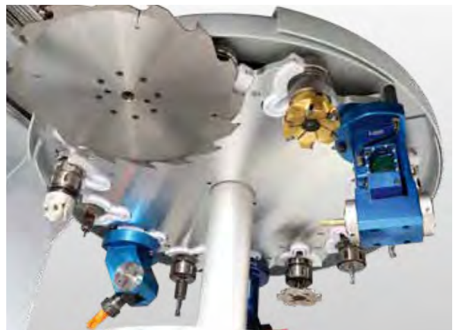
14位刀库 , 用于直径达200mm的刀具和转换头, 以及直径达350mm的锯片。
