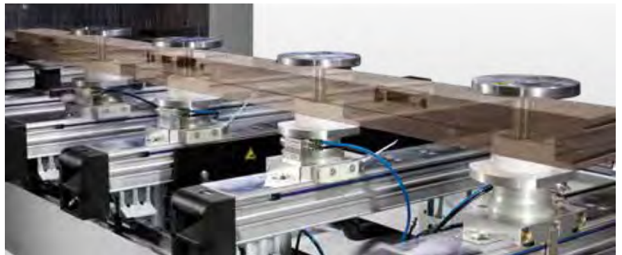
蘑菇头夹具 用于直和弯工件的手工夹紧。适用于所有弯曲、窄和框式部件。
