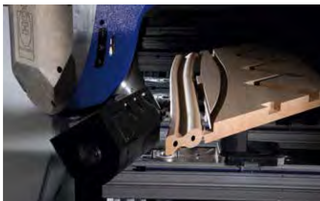
楼梯栏杆的特殊角度孔加工
