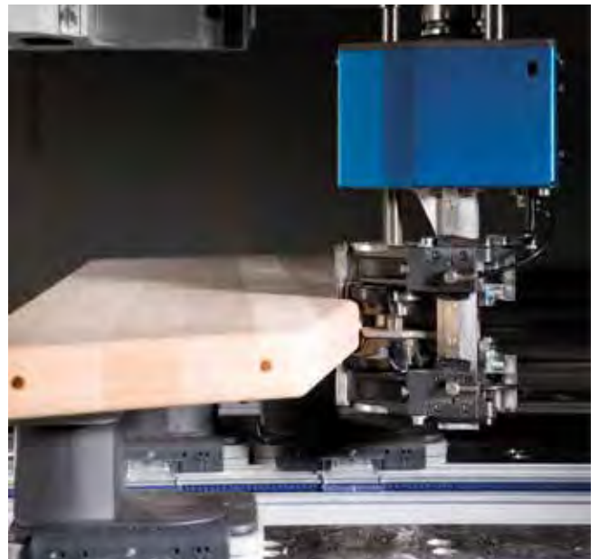
气动接口 — 所有C轴和5轴头上的3路支撑专利接口都可以使用跟踪单元, 例如, 无论厚度公差如何, 都可以精确地铣掉上面。
