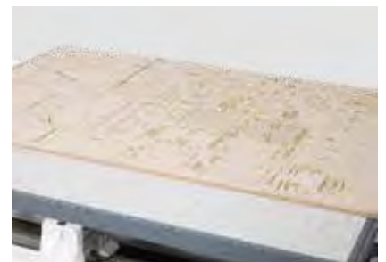
平台面转换台 也为装饰类工件提供了安全固定方案。大板套裁中的异型部件也能够“定制化”的在夹持梁台面中使用平台面转换台实现。
