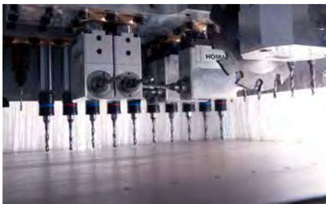
配备槽锯的高速钻孔技术
