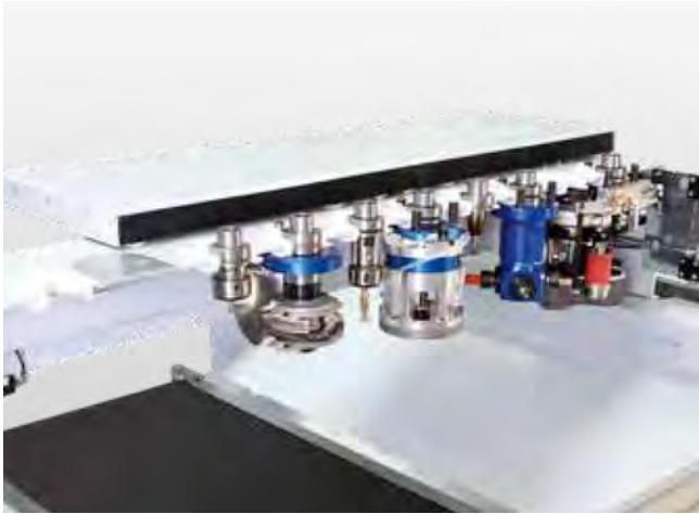
8位线性刀库 , 带有刀具传送站, 装于侧边。作为可选项, 还可以将 easyEdge 的抓取站集成进来。
