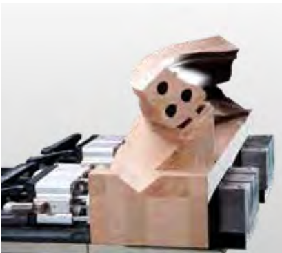
夹具 确保安全快速地夹紧框料和窗料。
