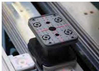
激光定位辅助 — 激光十字线指示吸盘位置。工件轮廓可以“移动”, 因为激光十字线自由移动成工件。
