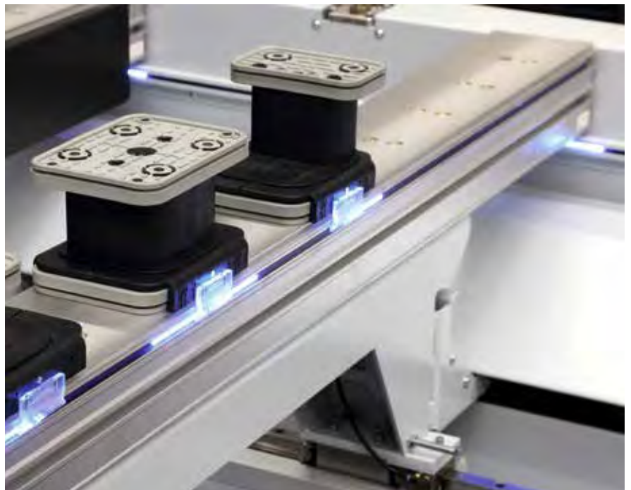
LED系统 — 非常快速、安全的夹持梁和吸盘定位系统。
