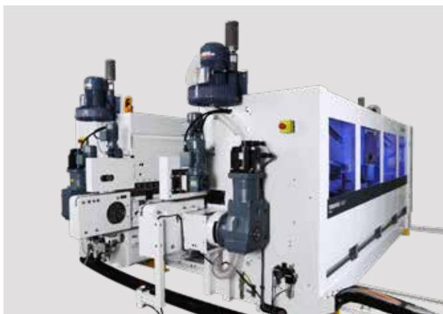
**驱动:** 输送系统独立驱动, 实现位置、速度和扭矩自动跟踪精准同步
