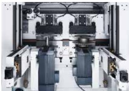
用于地板的压力和支撑垫，保护链条，确保精密加工，为加工单元区域内的工件提供附加支撑
