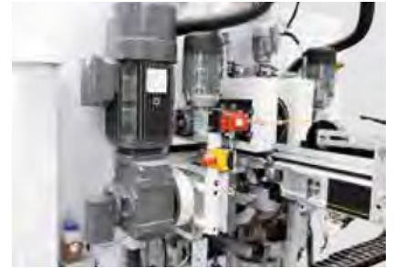
变频或伺服控制驱动系统, 确保稳定的进给速度, TENONTEQ D-600 (可选横向加工)
