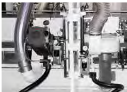
配高精度刀具水平及垂直定位装置和变频马达
