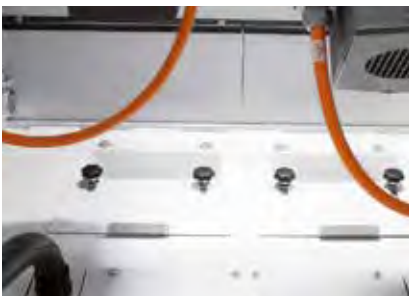
可选配置：机身延长，用于安装封蜡或倒角喷漆装置
