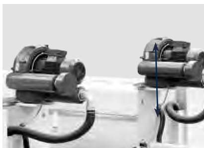
输送链导轨内低压通风装置
