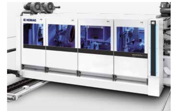
设备安全隔音罩, 用于降低噪音
