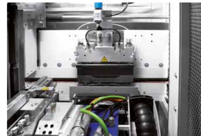
用于强化木地板生产的上压板和下压靴, 保护链条和保证加工精度
